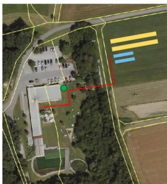
Abbildung 20: Schematische Darstellung der Flächen für Photovoltaik (gelb), Solarthermie (blau) sowie der Trasse für Wärme & Strom (rot). Grün dargestellt ist ein möglicher Standpunkt für einen außenliegenden thermischen Pufferspeicher. Quelle Bild: Bayernatlas
