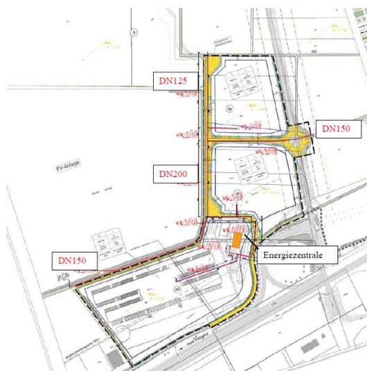
Abbildung 67: Kartographische Darstellung der Dimensionierung der Wärmeleitungen im Planungsgebiet
