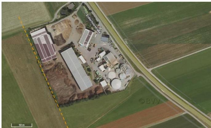
Abbildung 35: Luftbild der Firma KSK Käßmeyer mit den Biogasanlagen am unteren Rand des Betriebsgeländes. Die gelb gestrichelte Linie stellt die bestehende Erdgasleitung dar, die direkt am Betriebsgelände entlangläuft. (Quelle: Bayerische Vermessungsverwaltung)
