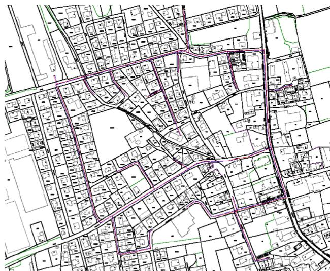
Abbildung 15: Möglicher Trassenplan für das geplante Nahwärmenetz im Ortskern der Gemeinde Benningen
